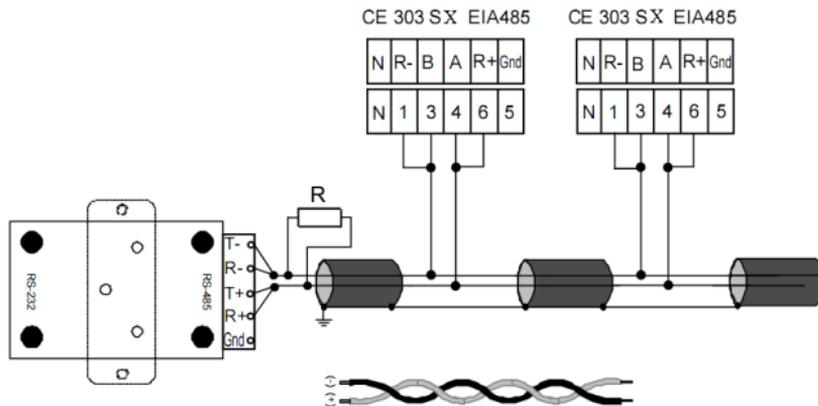
Резисторы растяжек (+R) и (-R) (номиналом 560 Ом, установлены в счетчик) подключаются только на крайних счетчиках в линии.
