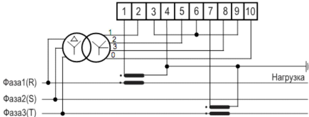
**Внимание!** Заземление цепей напряжения производить согласно схеме подключения трансформатора напряжения на объекте.
