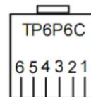
б) обозначение контактов ответной части разъема "19" TP6P6C
