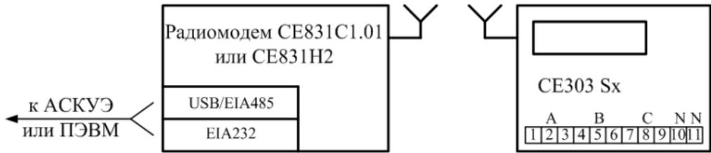
Рисунок 3.7 – Схема подключения счетчика
