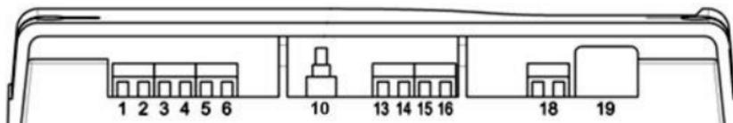
а) обозначение контактов счетчика СЕ303 S3x
