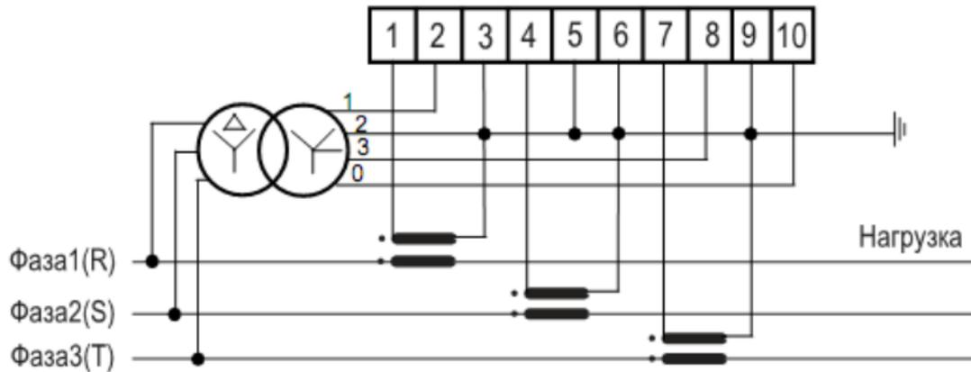
**Схема включения счетчика СЕ303 230 В 5(60)А; 5(100)А; 10(100)А**
