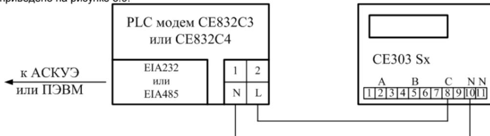
Рисунок 3.9 – Схема подключения счетчика
