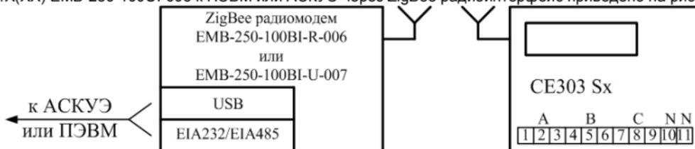
Рисунок 3.8 - Схема подключения счетчика
