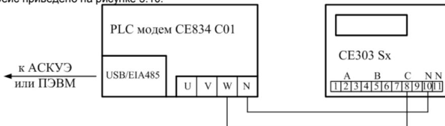
Рисунок 3.10 – Схема подключения счетчика
