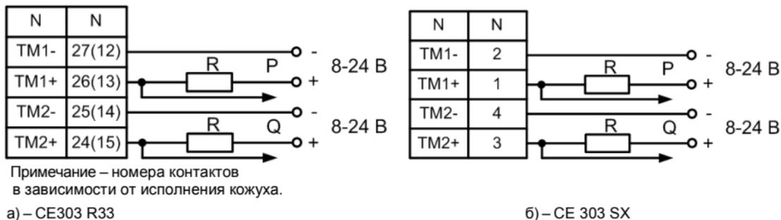
Рисунок 3.3 – Схема подключения импульсных выходов счетчика
