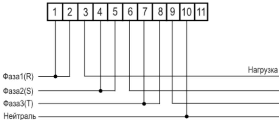
**ВНИМАНИЕ!** Перемычки между контактами 1 и 2, 4 и 5, 7 и 8 расположены на токовводной колодке счетчика. Перед подключением счетчика убедиться в том, что перемычки находятся в замкнутом состоянии.
